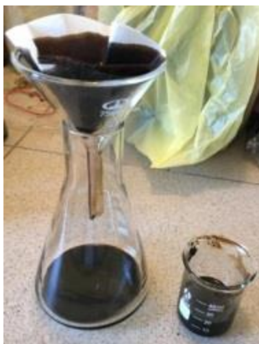
Рисунок 16 – Процесс экстрагирования нефтешлама через фильтровальную бумагу
