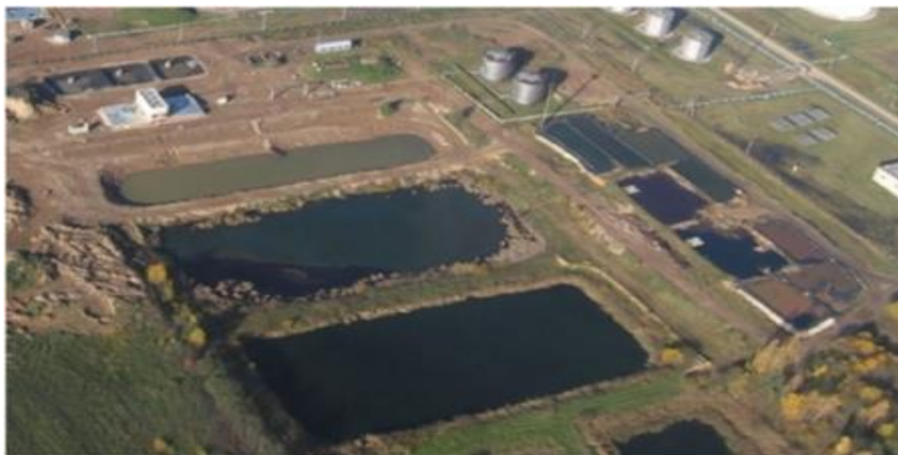
Рисунок 2 – Нефтешламовый амбар открытого типа
